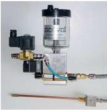
La **microlubrification**, appelée aussi **minimum quantity lubrication (MQL)** est utilisée pour introduire une **quantité précise d'un liquide** dans un processus.
